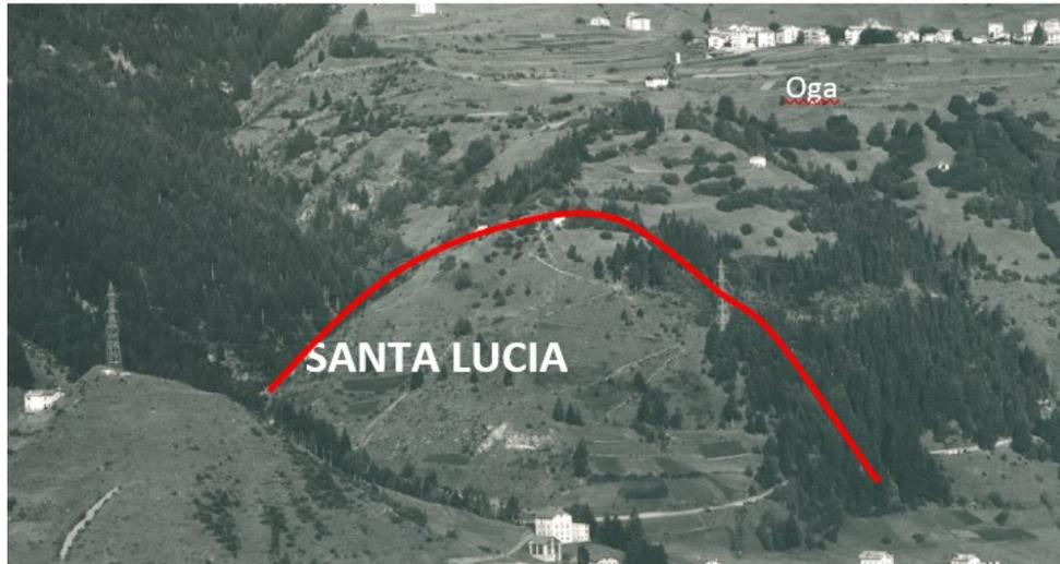
Figura 5: il versante negli anni '60, in gran parte non boscato. I dissesti principali si riscontrano nella parte boscata che sovrasta la strada e in quella della valle Cadolena, che insiste in parte sulla superficie di movimento principale della frana in atto. Il corso d'acqua che la percorre che affluisce nel F.Adda a Santa Lucia
