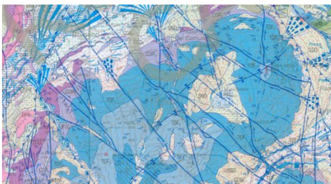
Figura 1 : Concentrazione di afflussi idrici creati da faglie trascorrenti di trazione dirette NO-SE verso le valli circostanti
