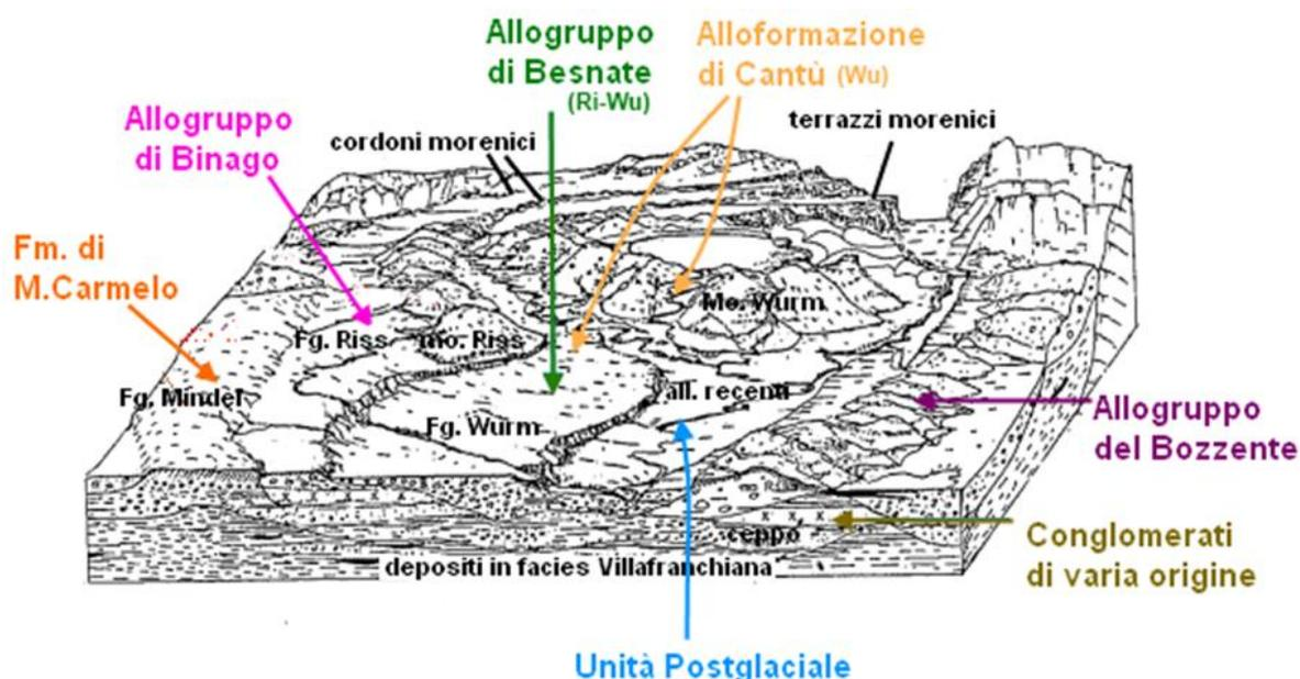
Figura 3- schema stratigrafico dell'area di interesse (da V. Francani, Idrogeologia generale, 1992), al quale sono stati aggiunte i termini delle alloformazioni corrispondenti ricavati dalla bibliografia (A. Bini, e al., 2004)
