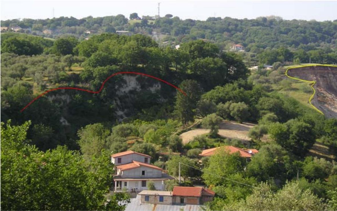
**Figura 9 - Evidenze di movimenti gravitativi in località Draga. Si osservi l'allineamento dell'antica scarpata (in rosso) con quella della recente attivazione del 15 febbraio u.s. (in giallo) visibile sulla destra della foto.**
