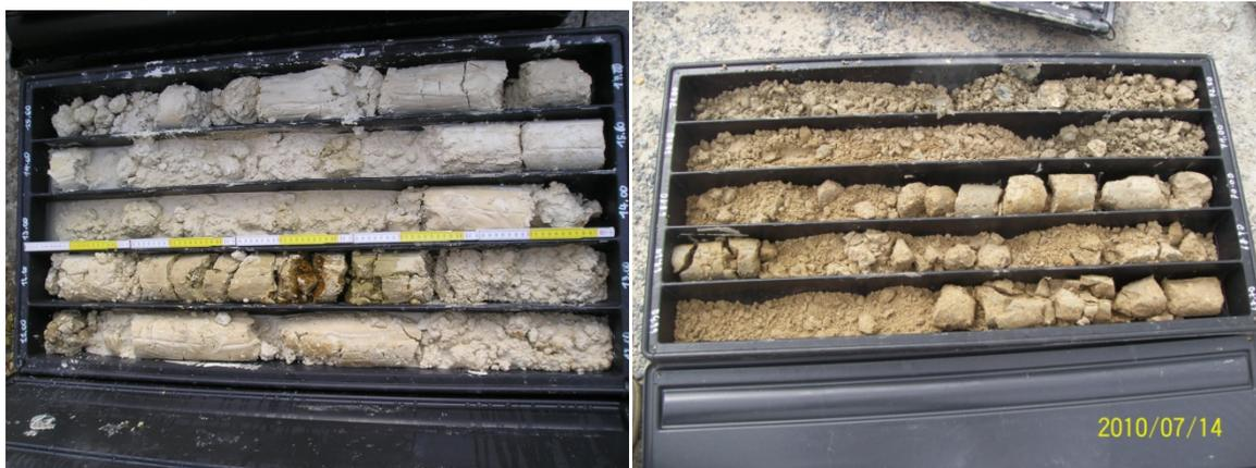
Figura 13 - Esempi di carote relative a: (a) calcari evaporitici, (b) arenarie mioceniche.
