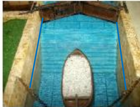
In questo modo la barca può raggiungere il livello superiore. Viene fatta passare dalla chiusa sopraelevata che si apre.
