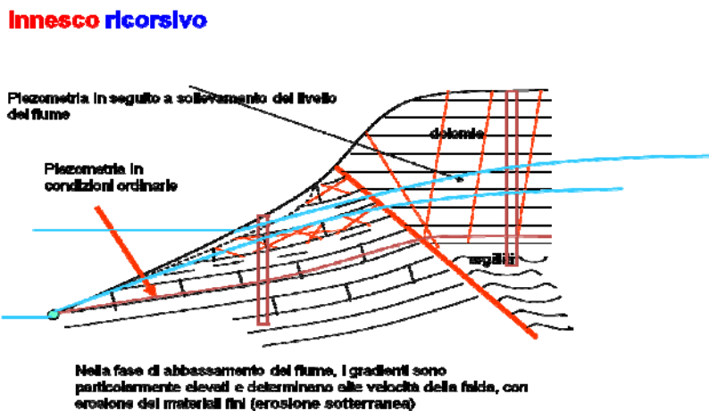
Figura 5b :nel caso dell'innesco ricorsivo, il fenomeno franoso è dovuto alla progressiva asportazione di materiale fine nel corso delle piene (erosione sotterranea). Nel corso delle precipitazioni più estese, il gradiente della falda che affluisce al corso d'acqua aumenta, e di conseguenza la velocità del flusso supera valori di soglia, oltre i quali avviene l'asportazione dal terreno di materiale fine (limo e sabbia). Il progressivo indebolimento del versante, dopo una serie anche lunga di episodi di piena ricorrenti, porta al collasso.
